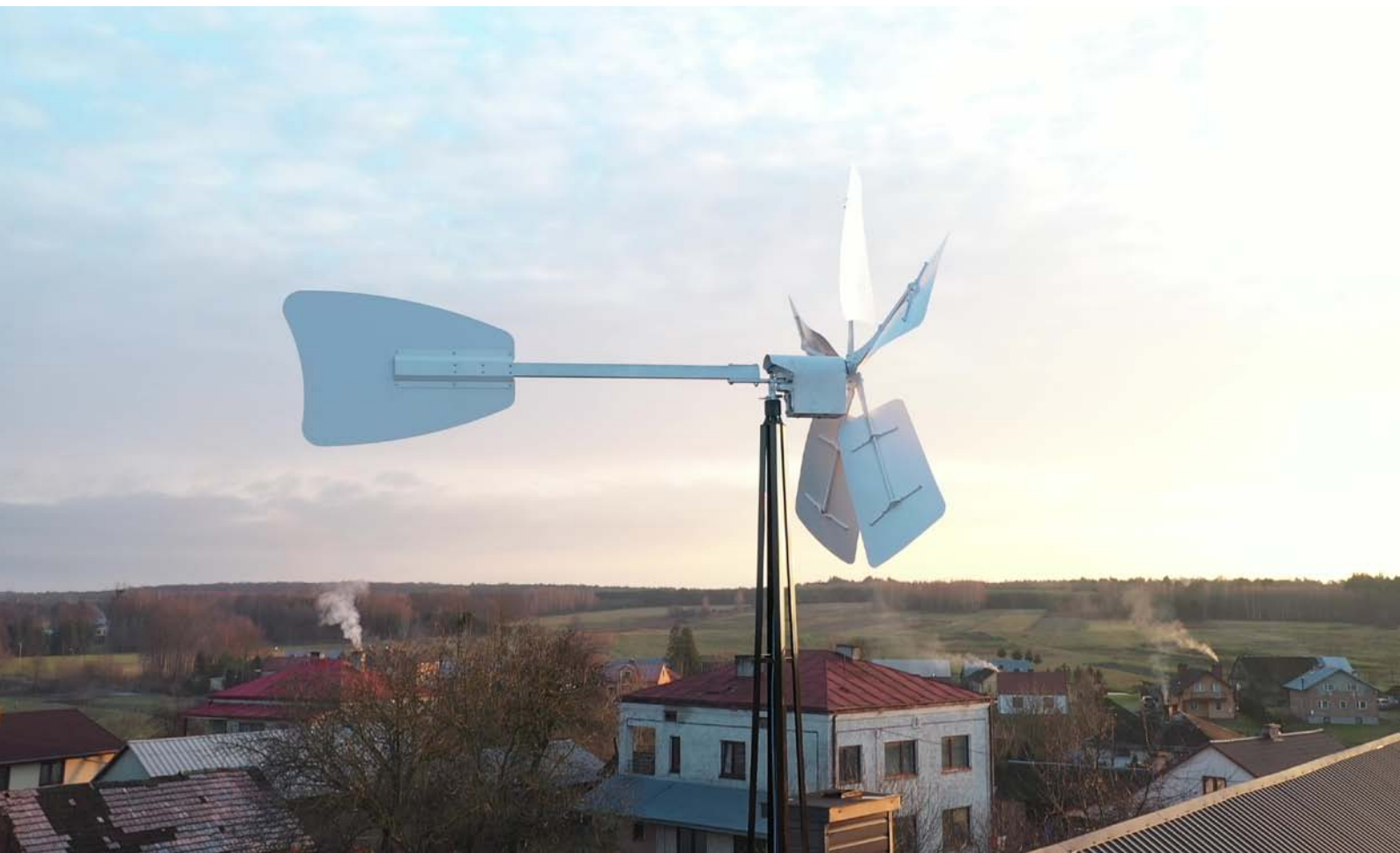
Turbiny marki PTS Investments zaczynają się kręcić już przy wietrze o prędkości 1-1,5 m/s
