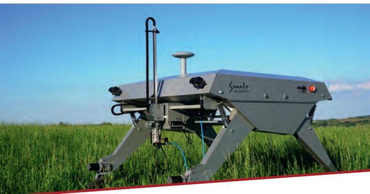
Fot. 1. Hugo – Robot Rolniczy – bezzałogowa platforma jezdna zintegrowana z technologią Hugo – Growth Stimulator.
