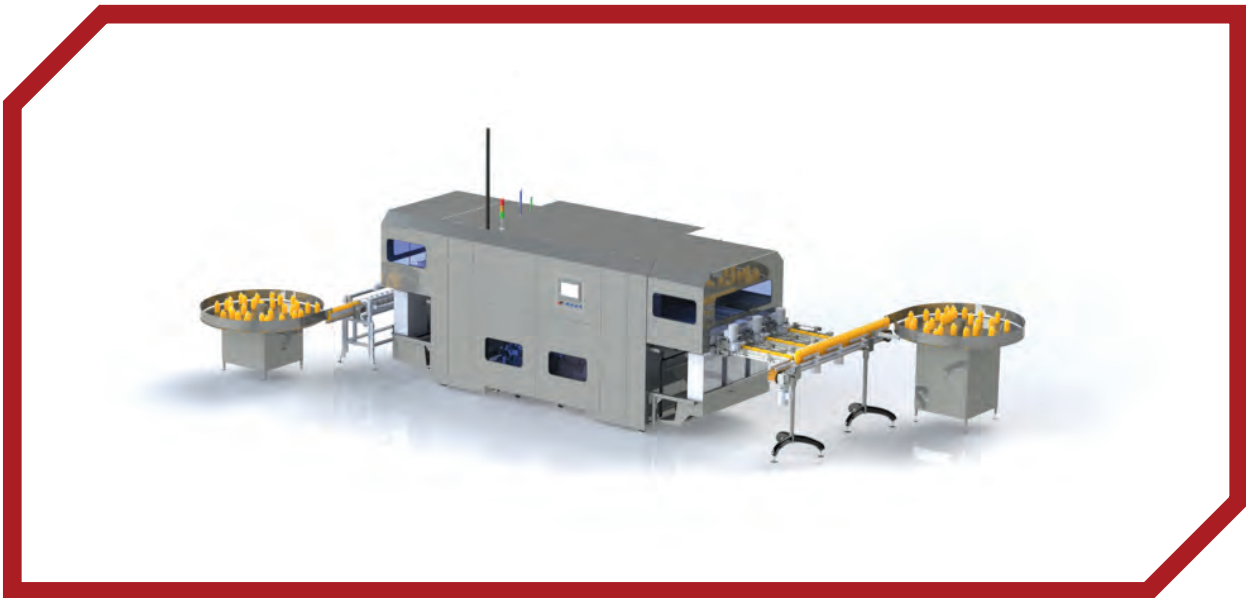
Fot. 3. Maszyna HPP.
