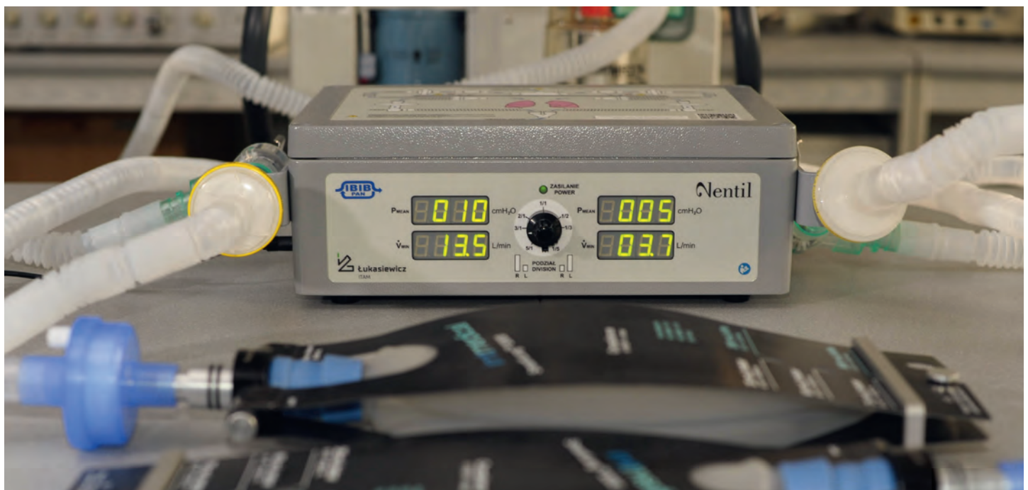
Fot. 3. Urządzenie VENTIL podłączone do respiratora oraz dwóch płuc testowych, zapewniające niezależną wentylację tych płuc w zadanej proporcji.
