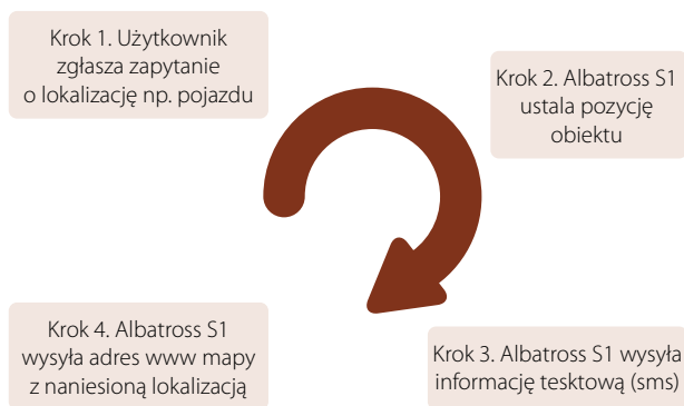
Rysunek 6. Sposób funkcjonowania usługi oferowanej przez Albatross GPS
