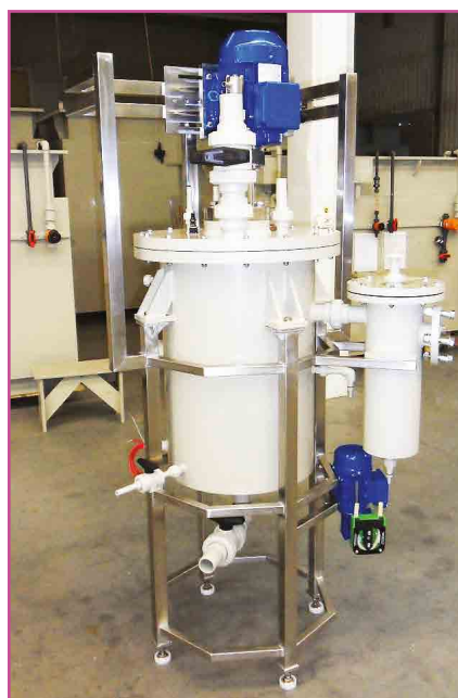
Reaktor laboratoryjny o pojemności 50 dm 3 stosowany do regeneracji kwaśnych roztworów chlorku miedzi
