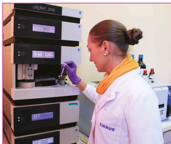
Aparat HPLC Dionex Ultimate 3000 - Chromatograf ciekłowy do ilościowego i jakościowego oznaczania składników żywic fenolowych, ICSO "Błachownia"
