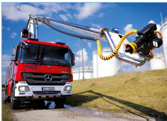
Ciężki samochód ratowniczo-gaśniczy z ramieniem gaśniczym typu HRET- zblizenie na ramię gaśnicze
