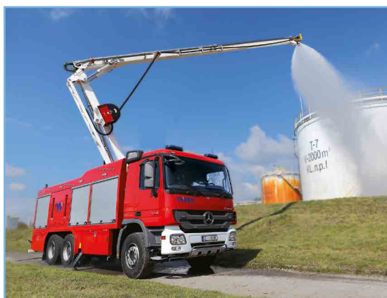
Ciężki samochód ratowniczo-gaśniczy z ramieniem gaśniczym typu HRET - rozłożone ramię
