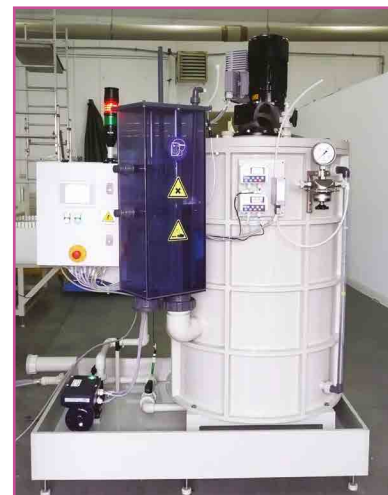
Reaktor R-050 o pojemności 500 dm 3 i wydajności utleniania miedzi(II) 20 kg/h stosowany do regeneracji kwaśnych roztworów chlorku miedzi
