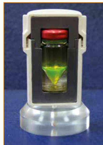
Przekrój pojemnika osłonnego do transportu materiału promieniotwórczego
