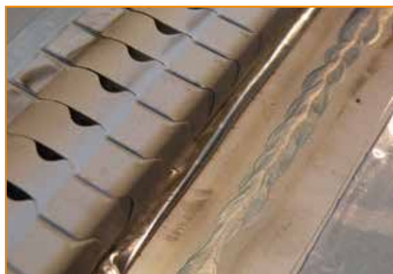
Podkładka bezpośrednio po spawaniu
