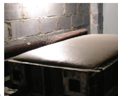
Wytwarzanie betonu komórkowego wg opracowanej technologii w skali laboratoryjnej (a) i w półtechnicznej (b).
