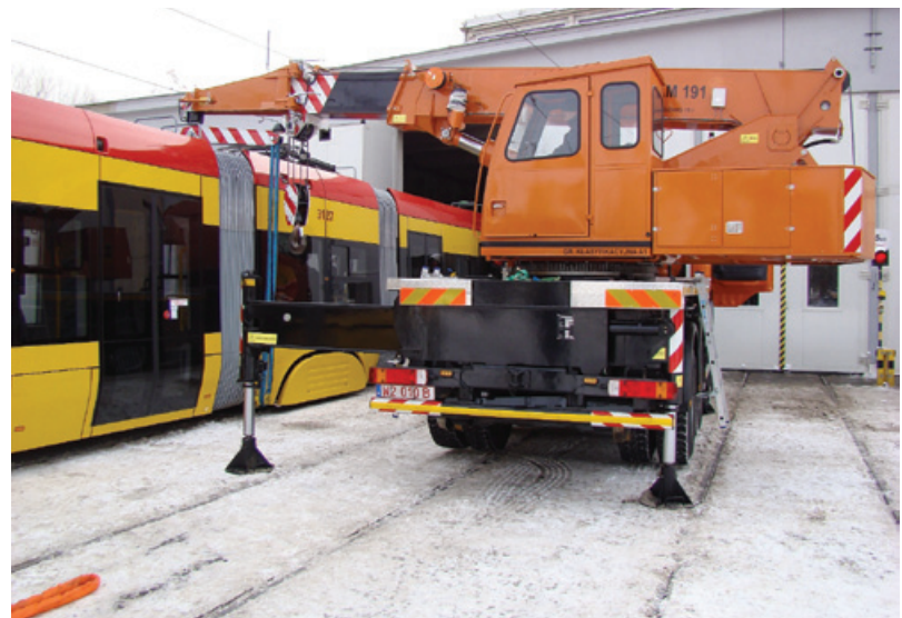
Podnoszenie członów środkowych tramwaju żurawiem ratowniczym TRAM typu 190
