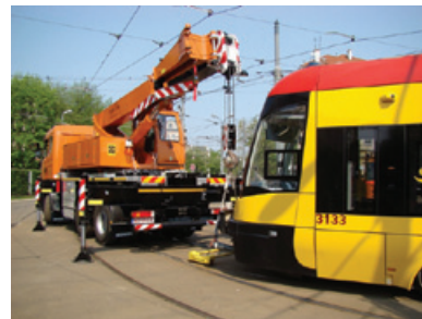
Podnoszenie członów skrajnych tramwaju żurawiem ratowniczym TRAM typu 190
